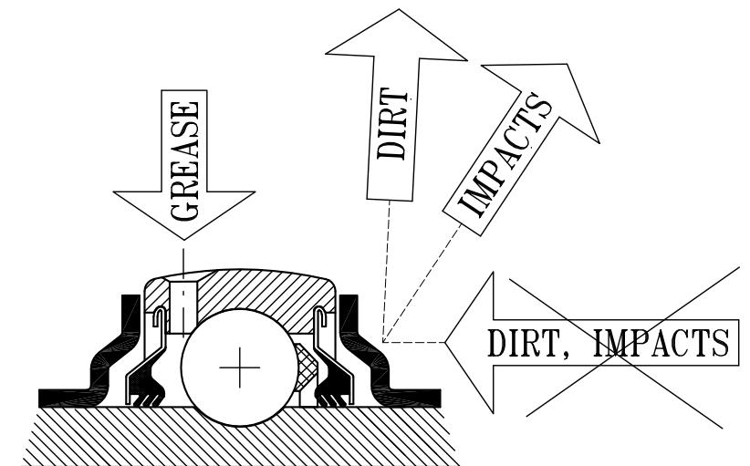
*Fig.12. Sealing 2TE*
